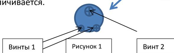
При регулировке конечного угла поворачивая по часовой стрелке, угол увеличивается, а против часовой стрелки угол уменьшается.
